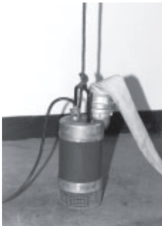
Arbeitsleine mit Mastwurf und halbem Schlag befestigt
