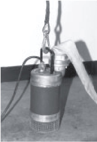
Arbeitsleine mit Karabinerhaken befestigt
